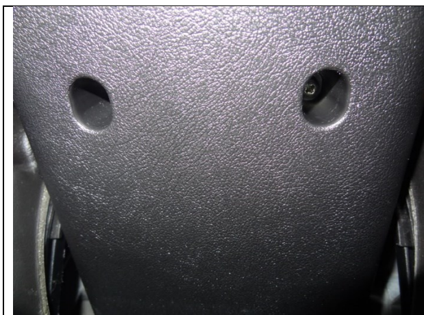
Tapa inferior del volante, la primera a retirar
