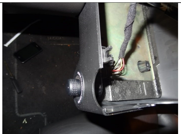
Interruptor de subir/bajar el volante a soltar
