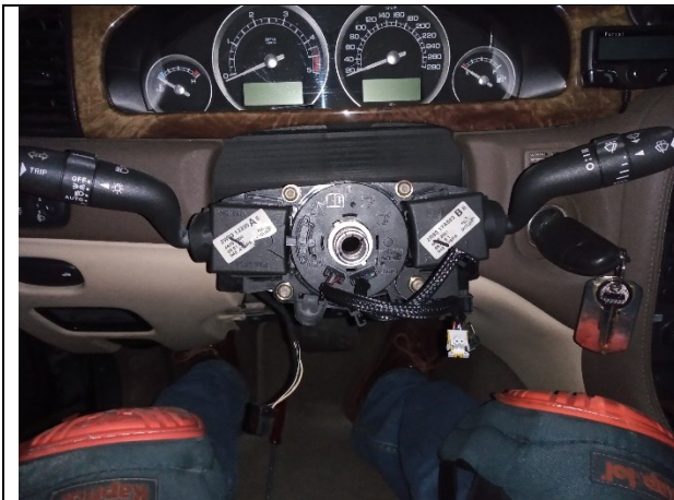
Marcas en el eje para montar el volante centrado
