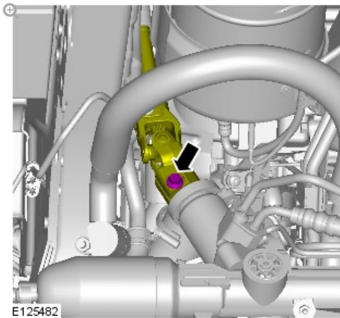
Remove and discard the bolt. Install a new bolt.
