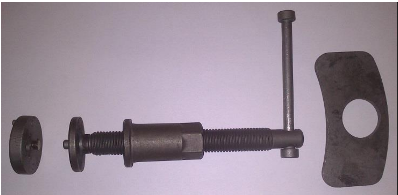
Reposicionador de pistón con giro a derechas para retranquear el pistón de las pinzas del eje trasero
