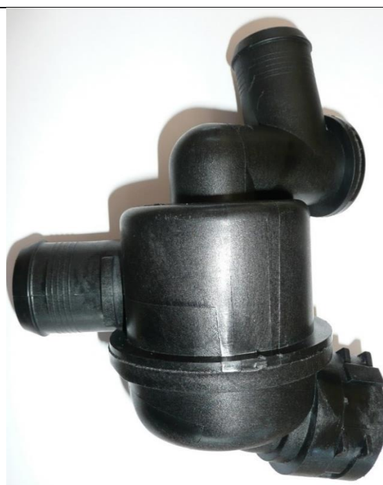
Termostato del motor 2.7D V6 que sustituí en mi vehículo. Es imposible saber la temperatura de apertura del termostato, porque no hay acceso al mismo, donde se supone que estará serigrafiado la temperatura de apertura.
