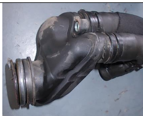
Obsérvese la degradación de la conexión al motor. No hubiese ocurrido si hubiese sido de aluminio
