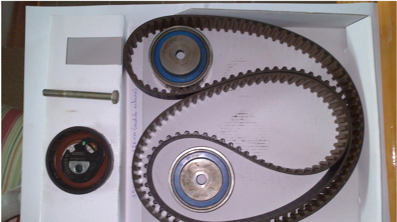
Componentes sustituidos del kit de distribución: 1 correa, 2 poleas locas, 1 polea-tensor y 1 tornillo hexagonal de fijar la polea-tensor.
