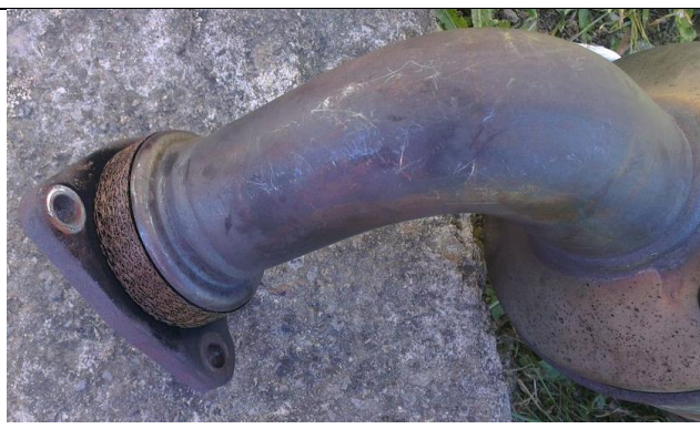
El flexible está oculto dentro de la malla de aluminio
