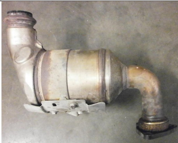
Catalizador extraído del sistema de escape
