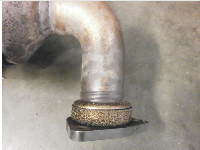
El flexible roto está detrás de la malla de aluminio
