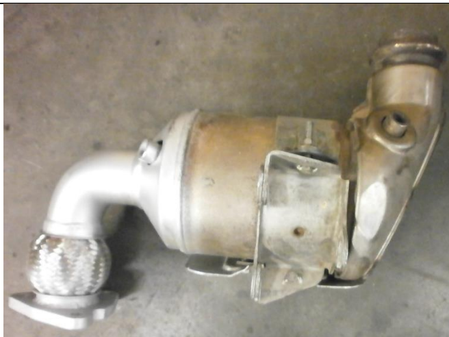
Catalizador con el flexible ya reparado
