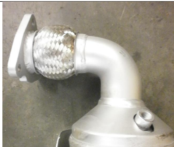
El flexible ha sido reforzado con malla de acero
